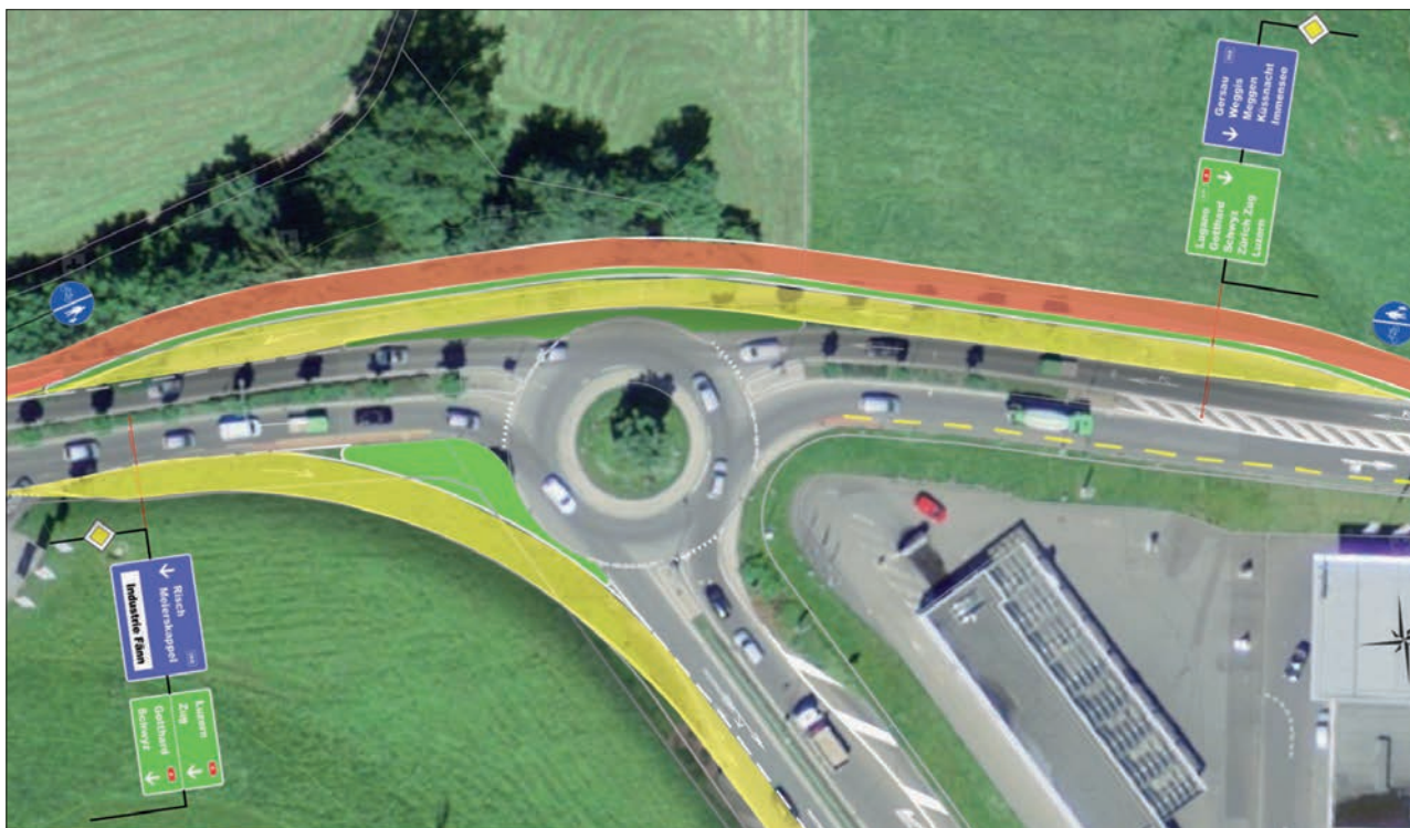
Per Petition fordert die SVP Küssnacht Sofortmassnahmen beim Fänn-Kreisel. Die Idee: Zwei Bypässe sollen den Verkehrsfluss verbessern. Gelb markiert sind die beiden Bypass-Spuren für Autos, rot jene für Velos und Fussgänger. Grafik: zvg/rk
